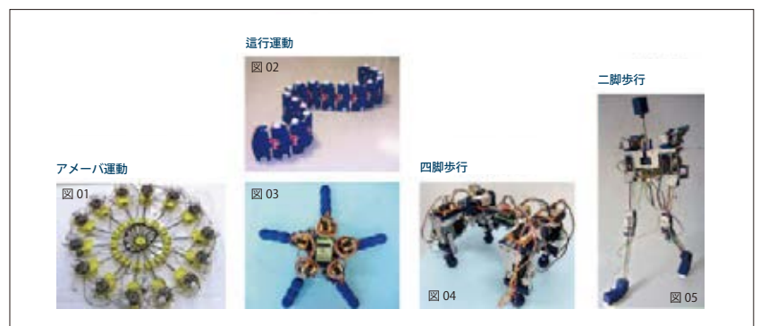
図 01: 真正粘菌変形体から抽出した自律分散制御系を実装したアメーバ様ロボット。全体を統御する制御系は一切持たない完全自律分散制御によって駆動している。
