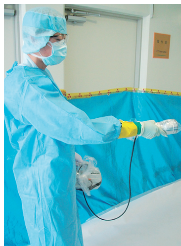
写真2 汚染を防ぐためビニールシートや濾紙等で養生されたPET検査棟内およびサーベイメータを持つスタッフ（サーベイメータもビニール等で被われている）
