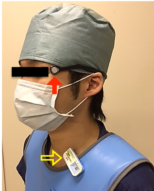
図 1. 左目付近(水晶体近傍)に装着(↑)した新しい水晶体線量計(DOSIRIS™) 新線量計は放射線防護メガネの内側にも配置することが可能であるため、防護メガネ装着時においても水晶体線量を測定できる。また当研究では写真のように頸部位置にも従来タイプの個人線量計を装着(⇨)して線量を評価し、水晶体線量との相関等を明らかにした。
