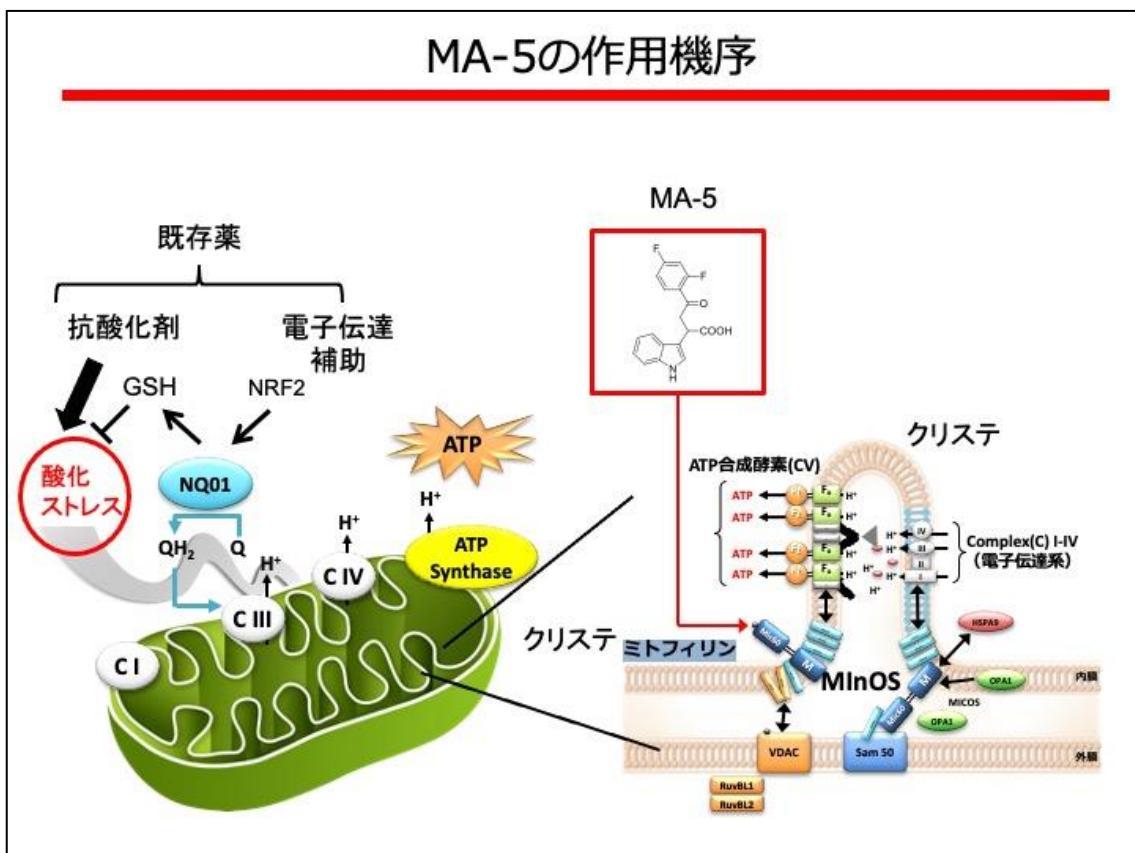
MA-5 は、ミトコンドリアの内部構造クリステを維持するタンパク質であるミトフィリンと結合し（右図の赤矢印）、ATP 合成酵素と複合体を形成することで、既存薬とは異なるメカニズムで生命活動に必要なエネルギーとなる ATP の产生効率を高めます。
